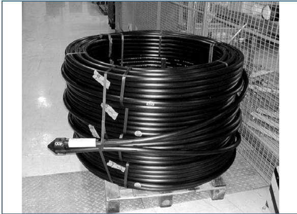
Abb. 6: Auf die Baustelle ange- lieferte Sondenbündel werden werkseitig auf- gerollt und auf die vor- gesehene Länge mit Sondenfuß gefertigt. (Frank GmbH)
