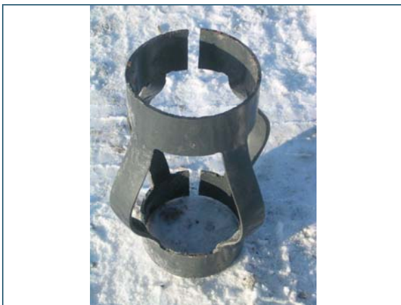
Abb. 4: Zentriereinrichtungen (links: Amt für Umweltschutz, Stuttgart; rechts: D. Urban)
